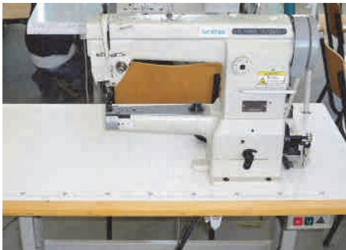
Слика 19. Машина за паспулирање – „лемилка“
