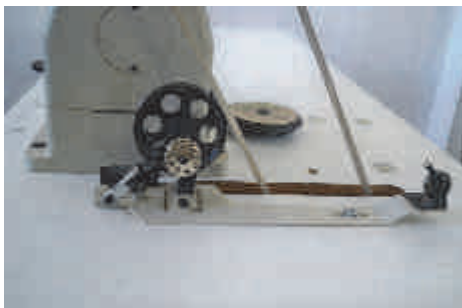
Слика 21. Доградена намотка на долен конец
